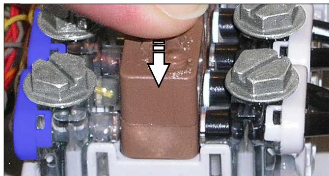
Убедившись, что защита ПРАВИЛЬНО установлена ВДАВИТЕ модуль до конца (уплотнительное кольцо будет внутри модуля).
