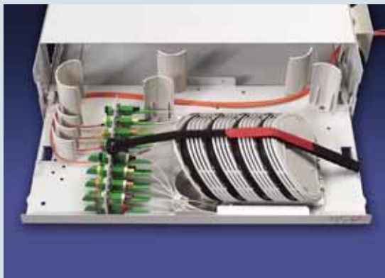
GMS2 панель с WDM и разветвителями
